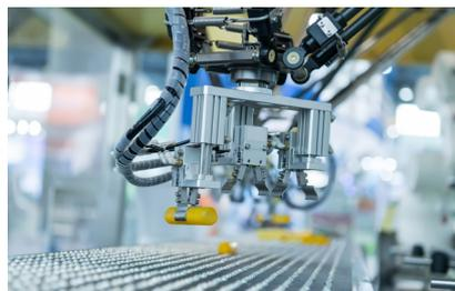
Die Zellen können sowohl als Einzelplatzlösung sowie als Systemlösung eingesetzt werden. Die Produkte werden z.B. mit einem Förderband dem Blickfeld der Kamera zugeführt, die Kamera erkennt die Lage und der Picker nimmt mit dem Greifer über Line-Tracking, in Verbindung mit der Lageerkennung das Produkt auf und übergibt es lagerichtig dem weiteren Produktionsprozess.
